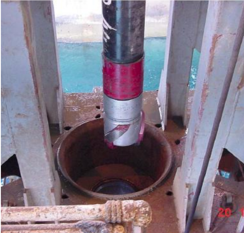
Рис. 4 Схема низа компоновки при бурении обсадными трубами.
