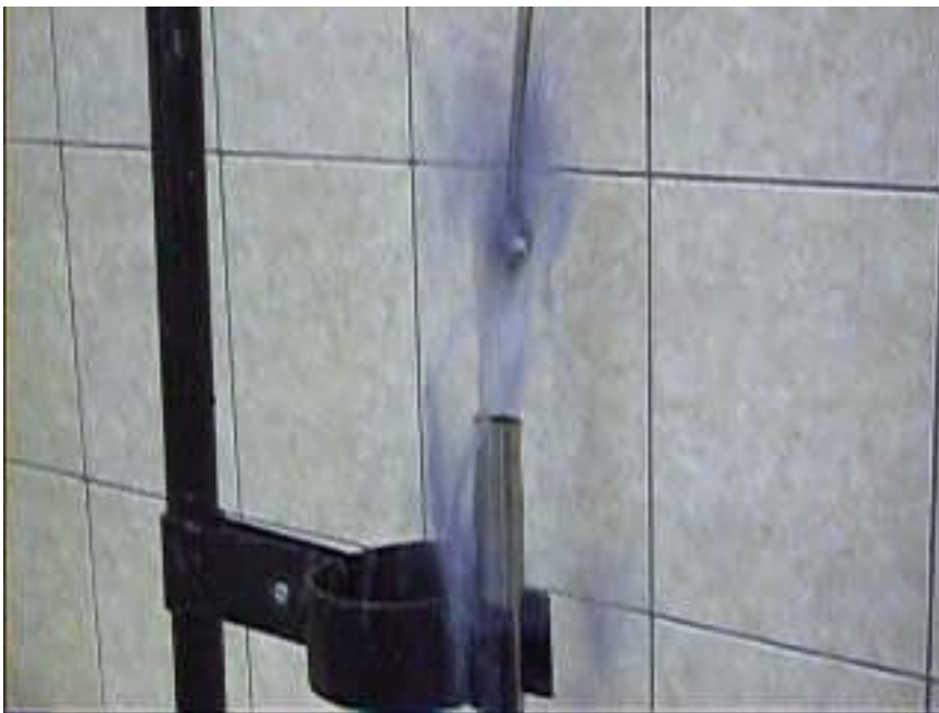
Рис.8 Выброс инструмента и БР в лабораторных условиях
